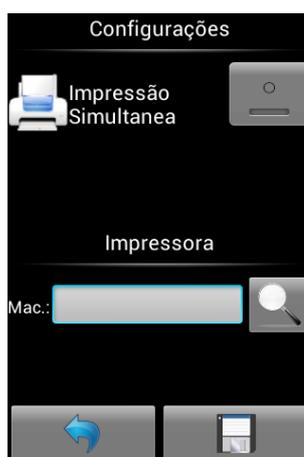
**Figura 13 - Tela de configuração de impressão simultânea.**
